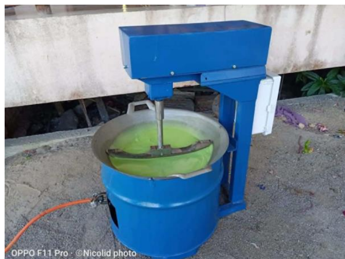
ภาพที่ 3: แสดงผลการสร้างเครื่องกวนขนมเปียกปูน
