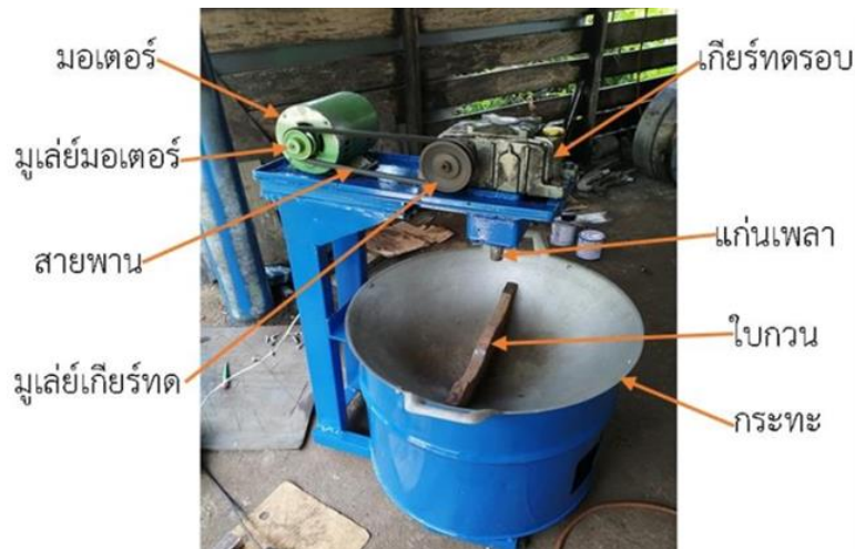
ภาพที่ 4: แสดงส่วนประกอบของเครื่องกวนขนมเปียกปูน
