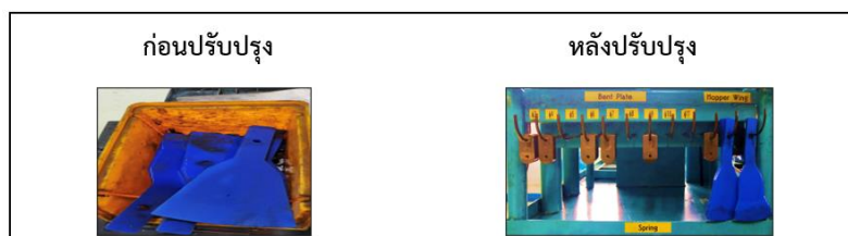
ภาพที่ 6: ตัวอย่างการแก้ปัญหาพนักงานใช้เวลาในการหาอะไหล่
